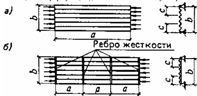
Черт. 12. Расчетная схема сжатого гофрированного листа
