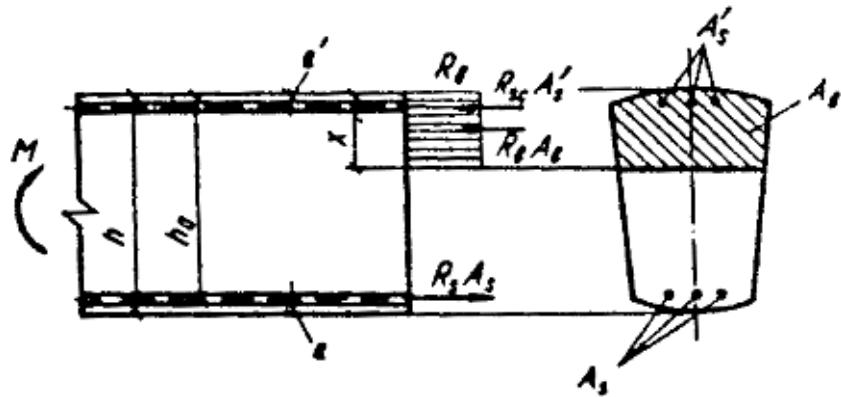
Черт. 2. Схема усилий и эпюра напряжений в сечении, нормальному к продольной оси изгибающегося железобетонного элемента, при расчете его по прочности
