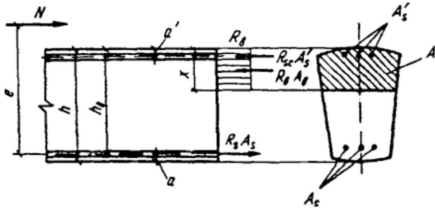
Черт. 3. Схема усилий и эпюор напряжений в сечении, нормальному к продольной оси внецентренно сжатого железобетонного элемента, при расчете его по прочности
