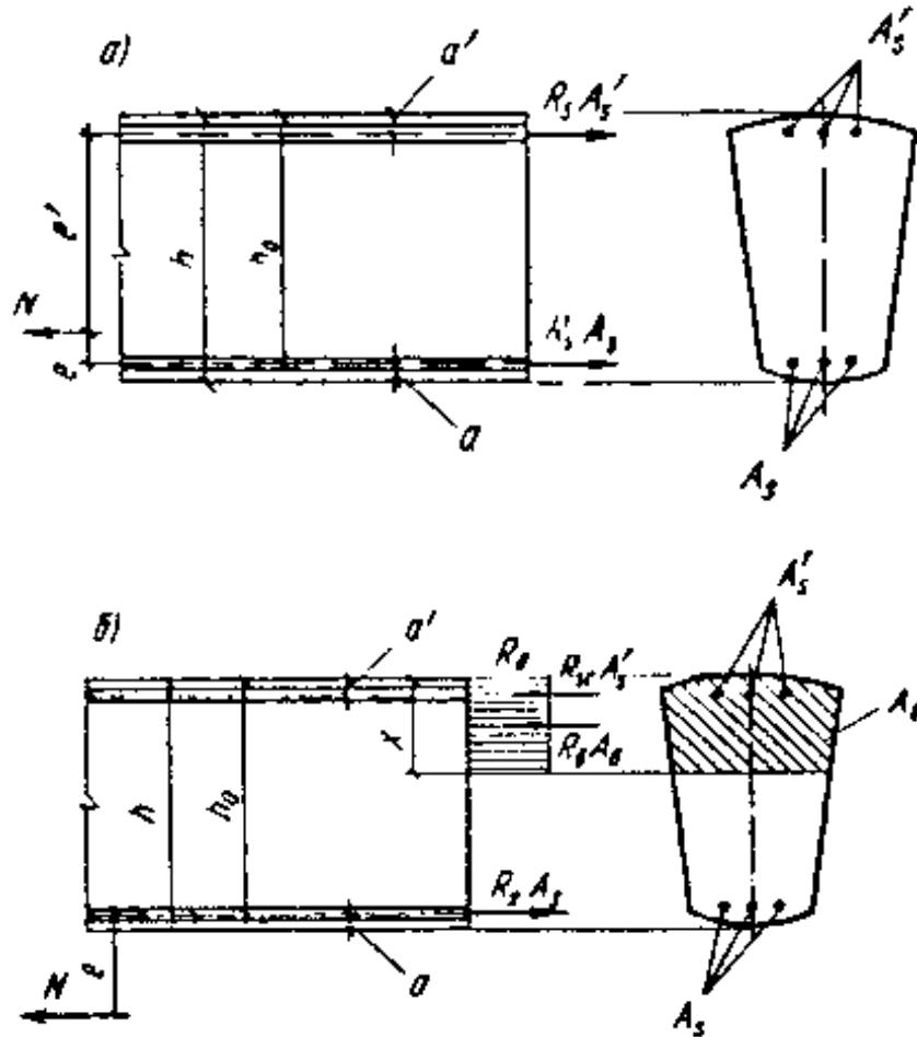
Черт. 4. Схема усилий и эпюра напряжений в сечении, нормальному к продольной оси внецентренно растянутого железобетонного элемента, при расчете его по прочности
