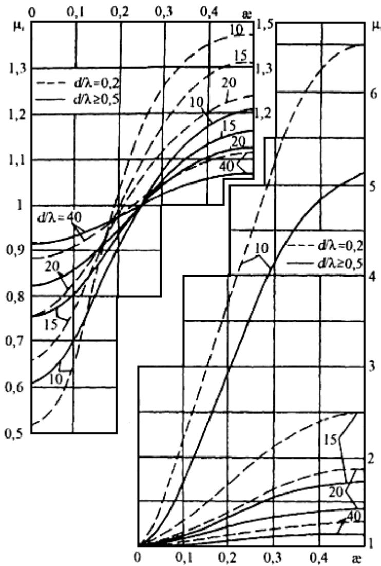
**Рисунок Е.8 - Графики значений инерционного  $\mu_i$  и скоростного  $\mu_v$  коэффициентов фазы**
