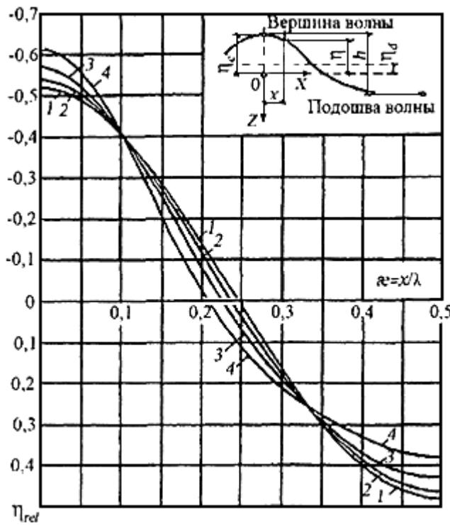
1 - при  $d/\lambda = 0,5$  и  $\lambda/d = 40$ ; 2 - при  $d/\lambda = 0,5$  и  $\lambda/d = 20$ , а также при  $d/\lambda = 0,2$  и  $\lambda/d = 40$ ; 3 - при  $d/\lambda = 0,5$  и  $\lambda/d = 10$ , а также при  $d/\lambda = 0,2$  и  $\lambda/d = 20$ ; 4 - при  $d/\lambda = 0,2$  и  $\lambda/d = 10$
