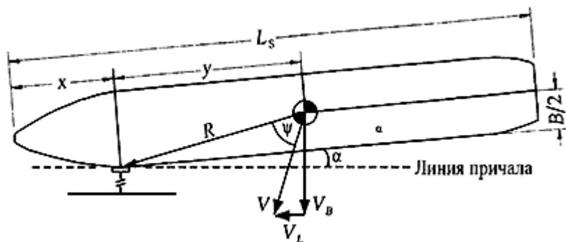
**Рисунок М.1 - Схема контакта судна с причалом**
