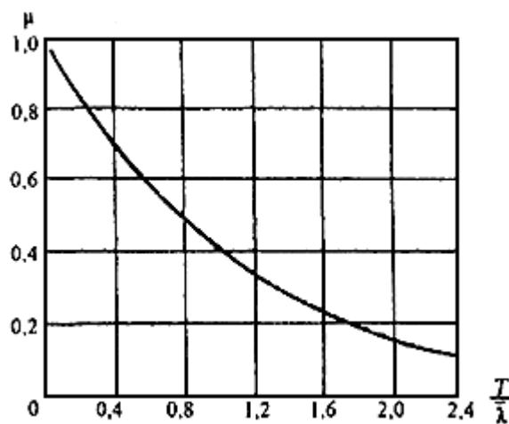
*Рисунок Л.2 - График для определения значения  $\mu$*
