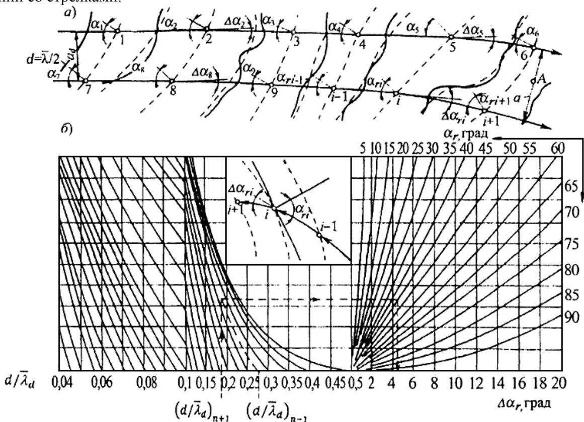
**Рисунок A.6 - Схема (а) и графики (б) для построения плана рефракции**
