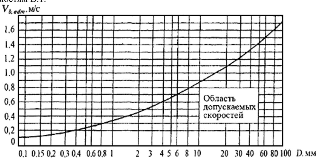
**Рисунок В.1 - График допускаемых значений скоростей**
