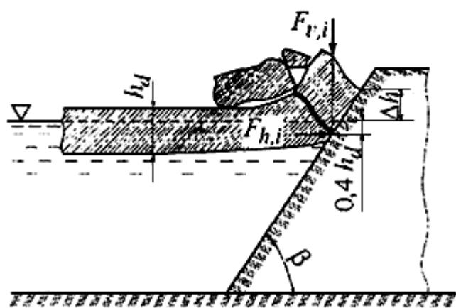
**Рисунок 21 - Схема приложения нагрузок от движущегося ледяного поля на сооружение откосного профиля**
