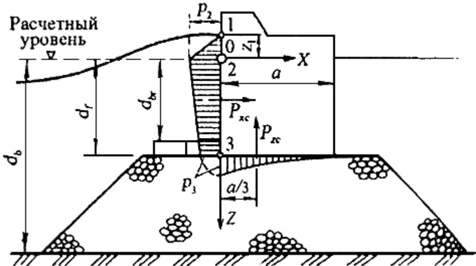
**Рисунок 5 - Эпюры давления разбивающихся волн на вертикальную стену**
