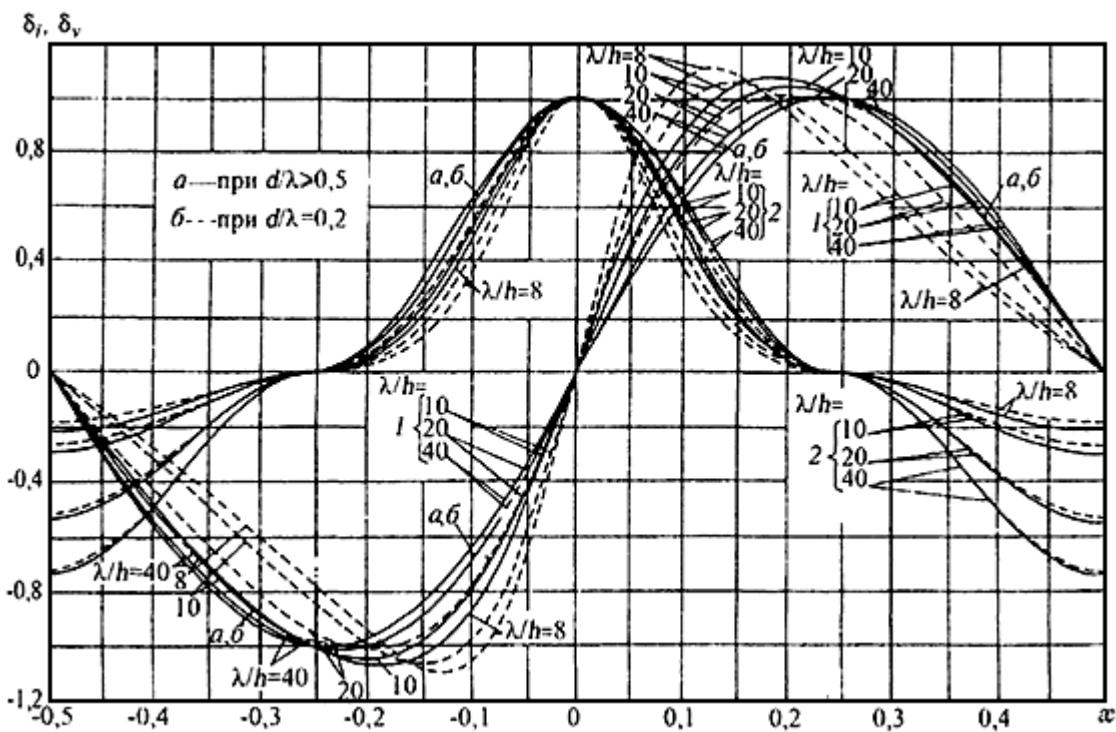
Рисунок Е.1 - Графики значений коэффициентов сочетания инерционного  $\delta_i$  (графики 1) и скоростного  $\delta_v$  (графики 2) компонентов силы от воздействия волн
