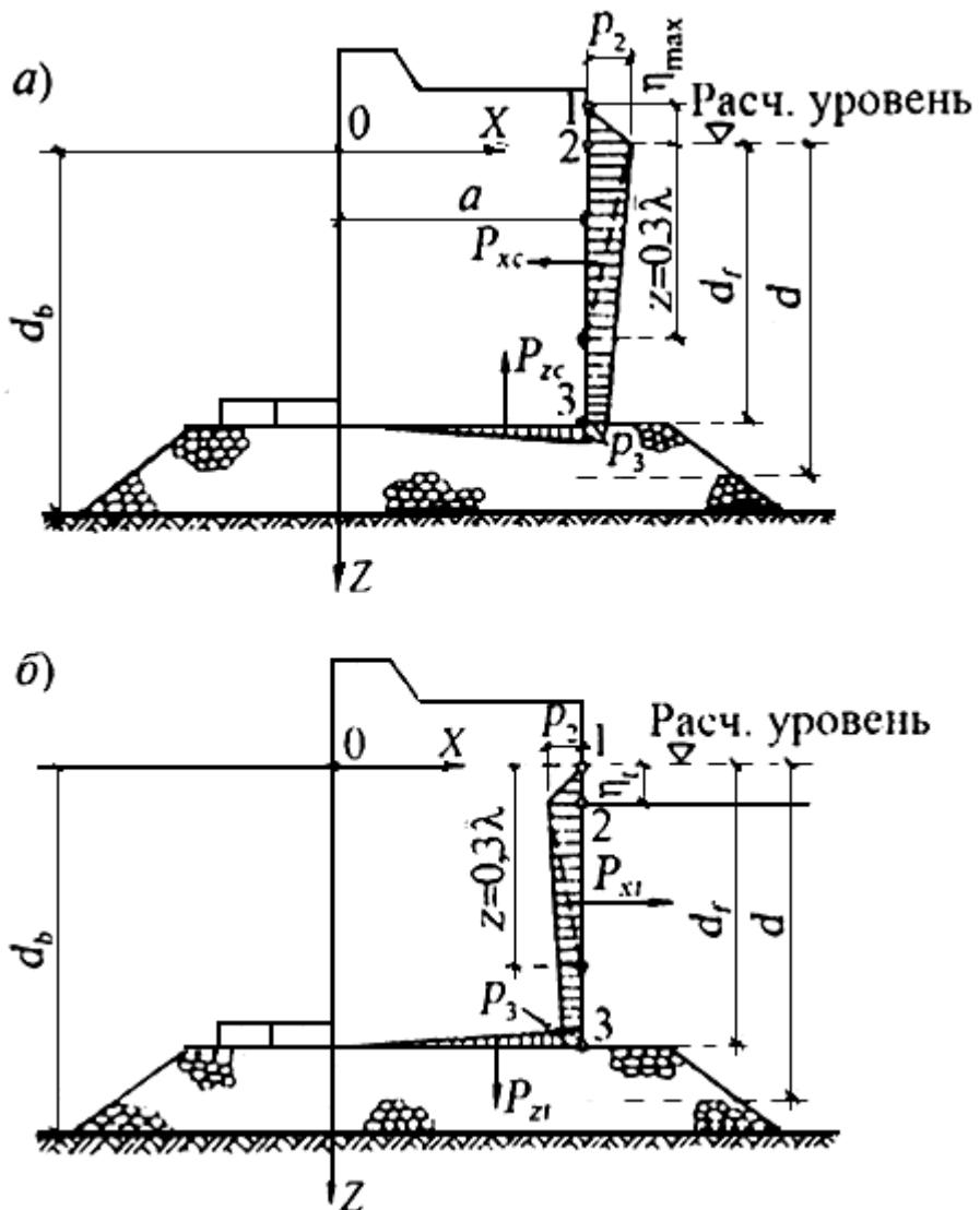
*a* - при гребне волны; *б* - при ложбине волны
