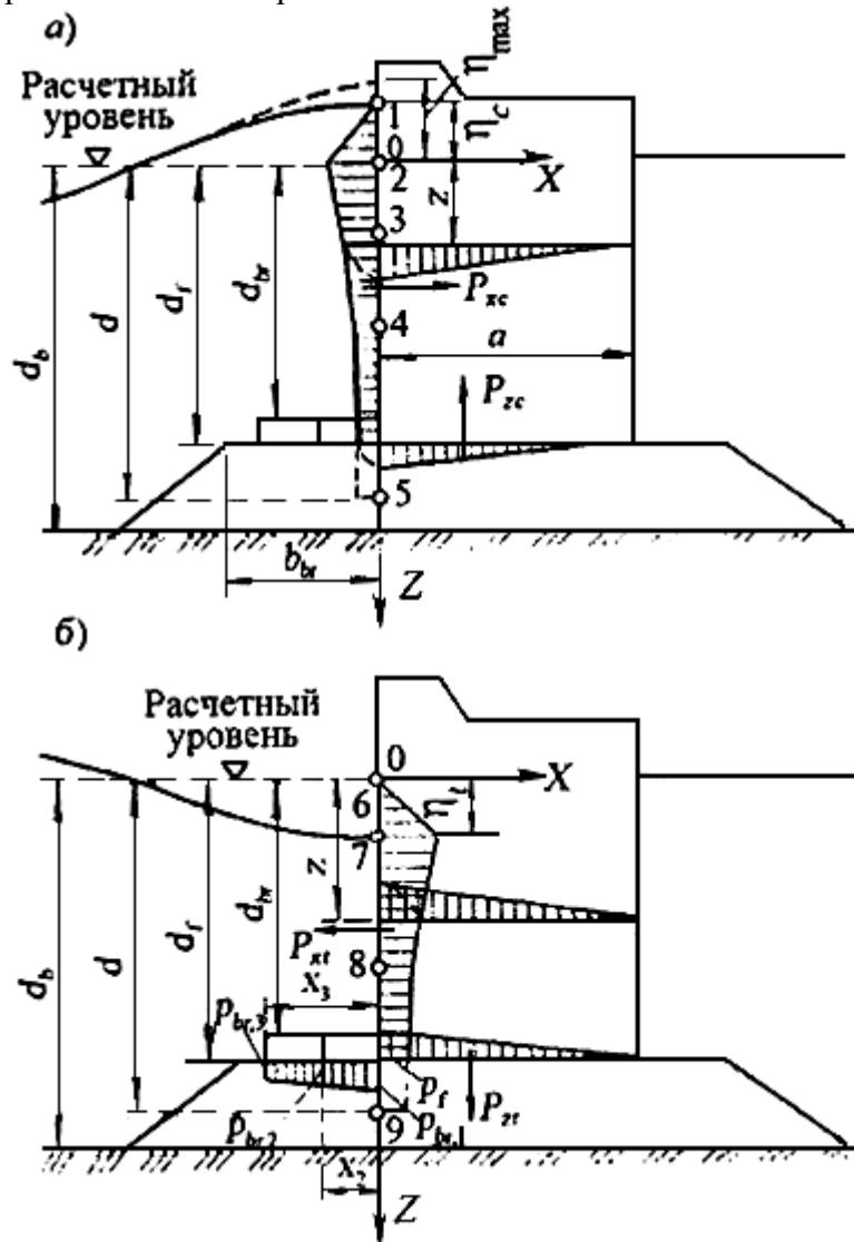
$a$  - при гребне волны;  $b$  - при ложбине волны (с эпюрами взвешивающего волнового давления)
