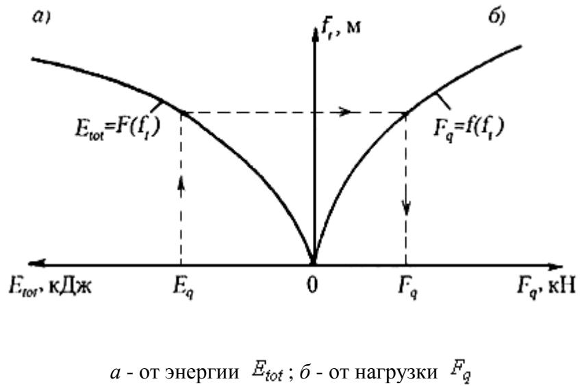
**Рисунок 16 - Схема построения графиков зависимости деформаций отбойного устройства (и причального сооружения)  $f_t$**
