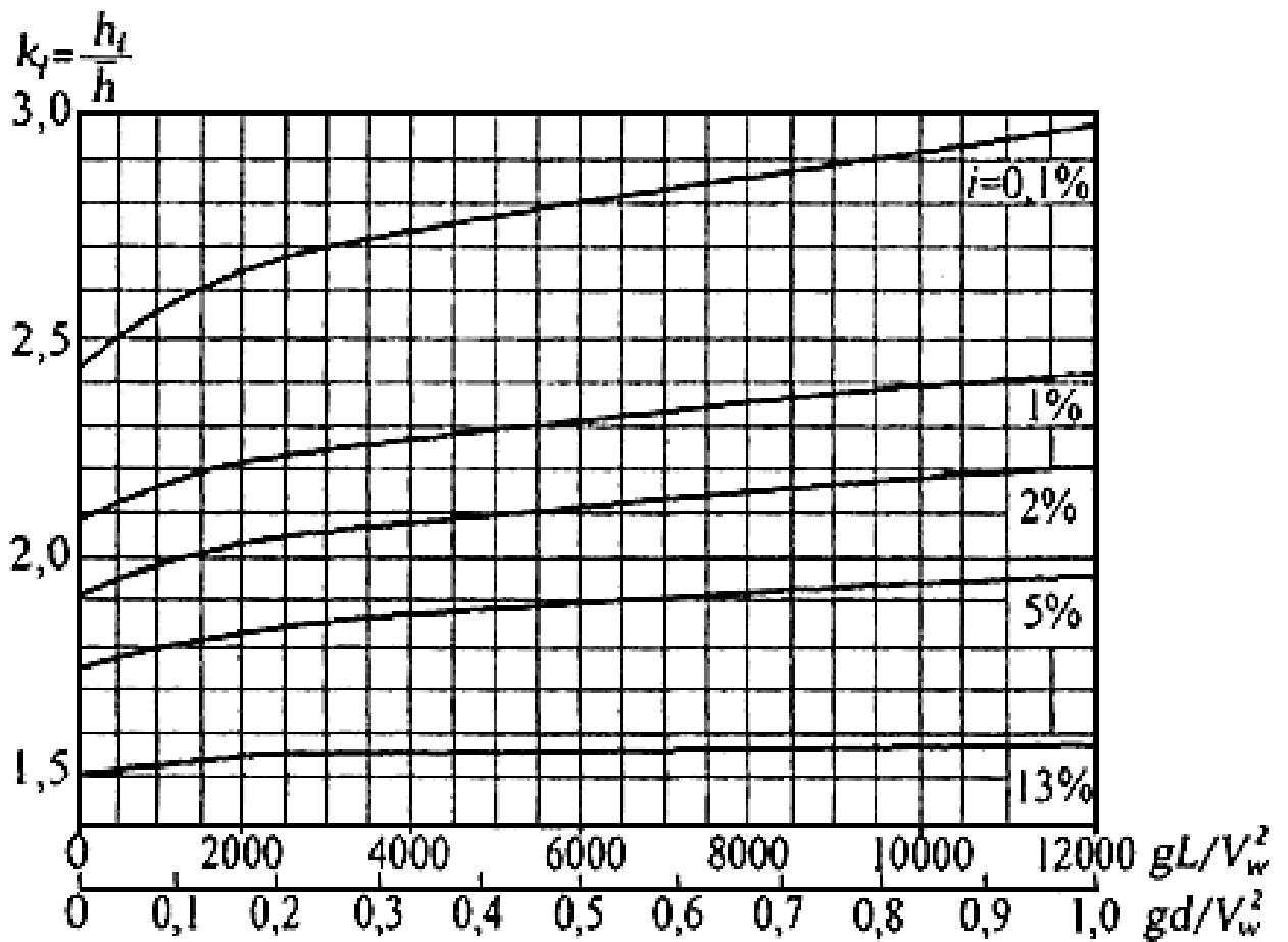
*Рисунок A.2 - Графики значений коэффициента  $k_i$*
