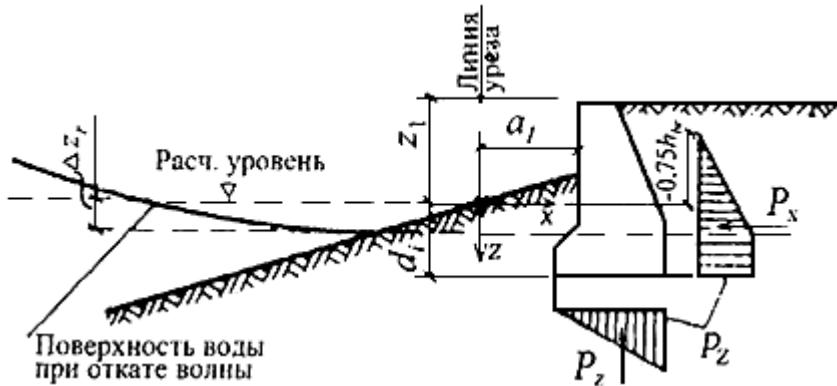
**Рисунок 11 - Эпюры волнового давления на вертикальную волнозащитную стену при откате волны**
