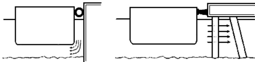
a - сплошная конструкция; б - сквозная конструкция
