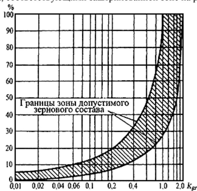
Рисунок В.2 - График для определения допустимого зернового состава
