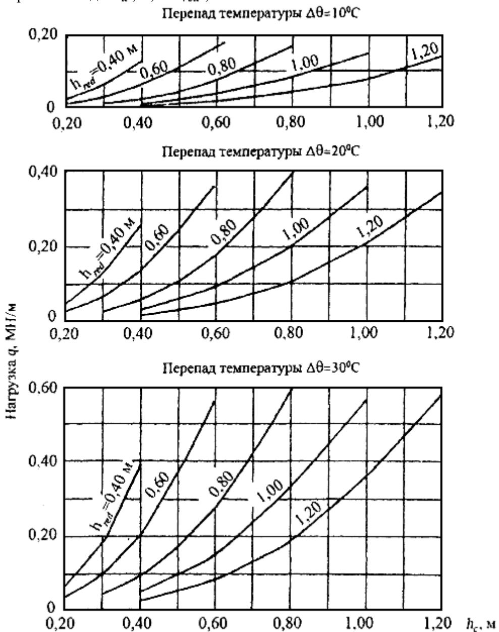
**Рисунок 23 - График значений нагрузки  $q$  при температурном расширении пресного льда**
