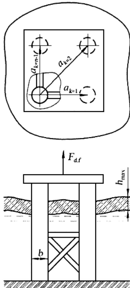
**Рисунок 26 - Схема приложения нагрузки к сооружению, состоящему из системы вертикальных колонн, от примерзшего к нему ледяного покрова при повышении уровня воды (при понижении уровня воды сила  $F_{d,f}$  направлена вниз)**
