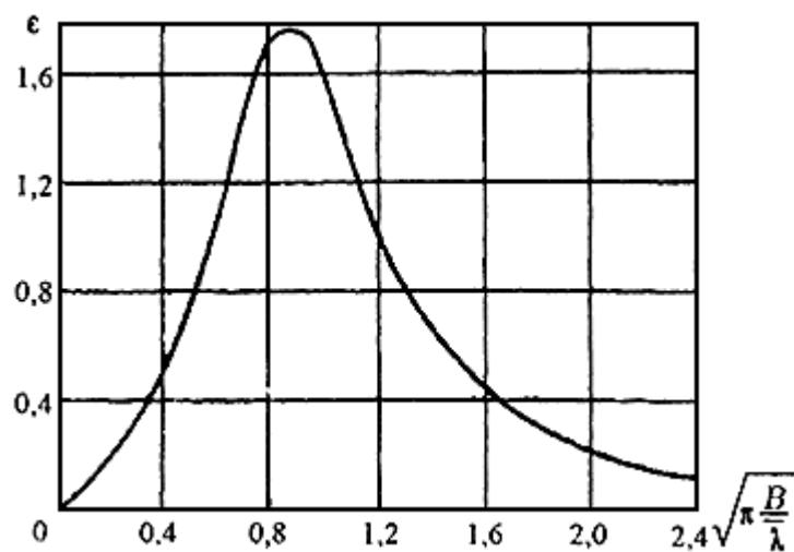
*Рисунок Л.3 - График для определения значения  $\varepsilon$*
