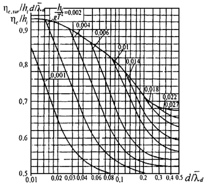
**Рисунок А.3 - Графики для определения значений  $\eta_c / h_i$  в мелководной и  $\eta_{c,sur} / h_i$  в прибойной зонах**
