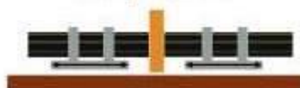
5. Нагрев и оплавление торцов труб
