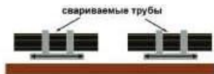
1. Подготовка и центровка ПЭ труб
